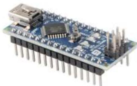
Рисунок 7 – Аппаратная платформа Arduino Nano
